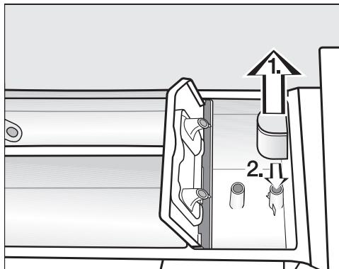
1. Izvadite usisnu cevčicu iz pregrade ☘ i operite je pod mlazom tople vode. Takođe operite cev iznad koje se postavlja usisna cevčica.
